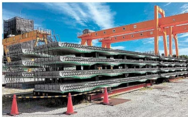
工場で製造したプレストレスト・コンクリート床版。プレキャスト製品の低炭素化を推進していく＝本巣市曾井中島、安部日鋼工業岐阜本巣工場
